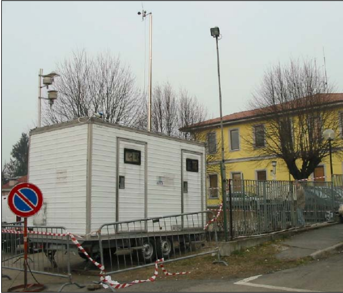
Figura 23.1 – Laboratorio mobile utilizzato per la campagna di monitoraggio nel Comune di Casorate Sempione.
